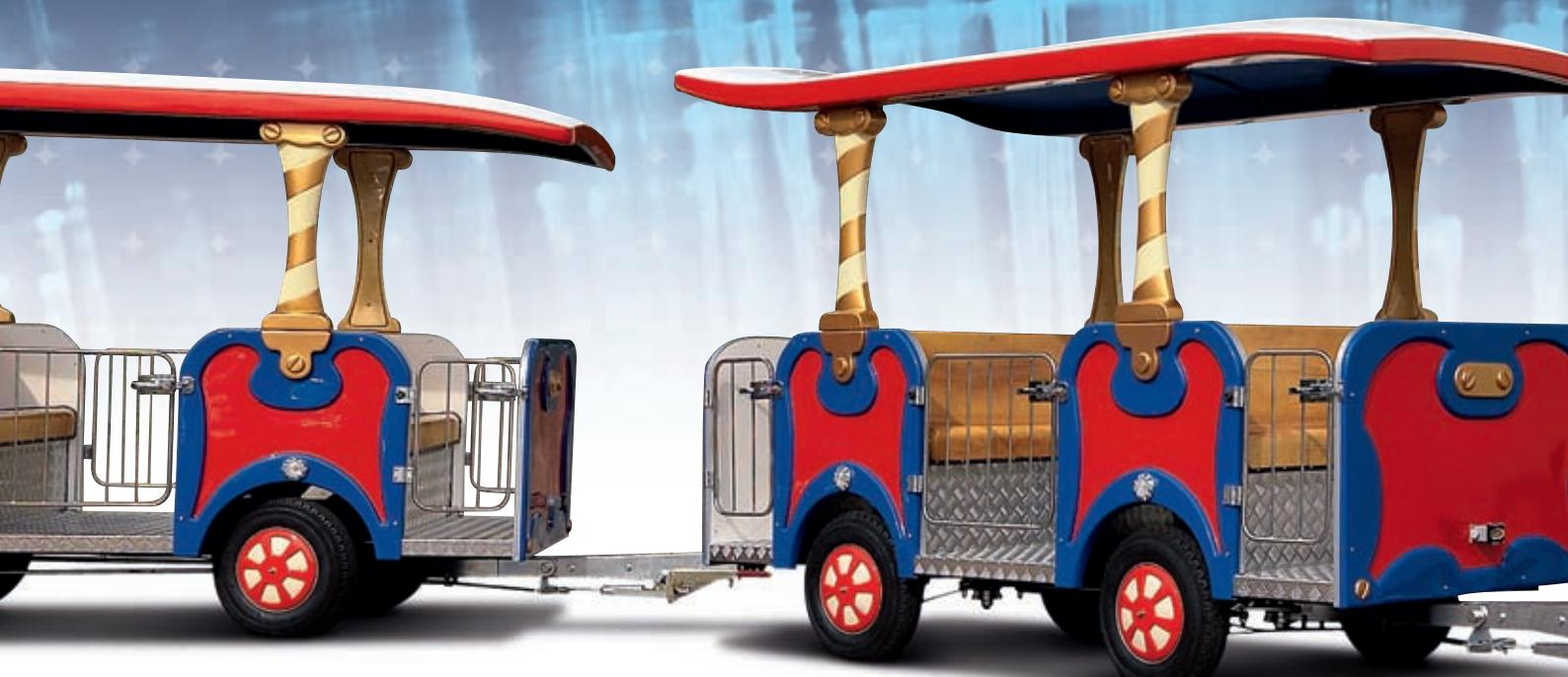
Sur la figure le modèle Green Express ELECTRIQUE avec voitures à 8 places; équipé de grilles sur les voitures. L'installation sonore est de série et est fournie avec chargeur de 220V. Le chargeur de 380V est disponible sur demande.
